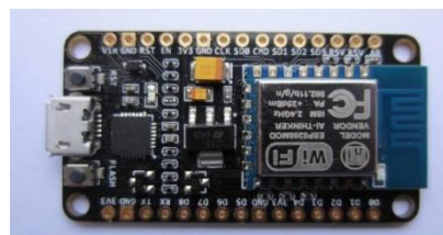
Gambar 2.1 Bentuk fisik NodeMcu 8266 (Sumber: www.esp8266.com ).
